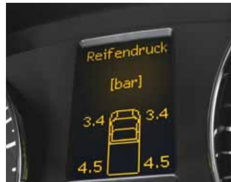
● **Système de contrôle de la pression des pneus<sup>2</sup>.** Garantit une sécurité accrue et réduit la consommation de carburant et l'usure des pneus.
