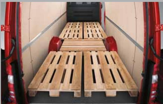
● **Espace de chargement.** Pour une exploitation optimale de l'espace, le compartiment de chargement présente des parois intérieures presque verticales, des caissons de roues aplatis et offre jusqu'à 2695 kg de charge utile.
