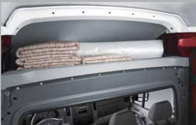
● **Rangement au-dessus du ciel de pavillon.** Sur les modèles à toit surélevé ou super surélevé, un compartiment ménagé entre le toit et le ciel de pavillon offre un espace de rangement supplémentaire.
