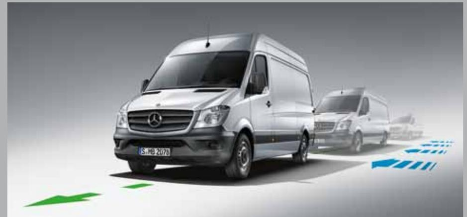
Le système de stabilisation en cas de vent latéral utilise les capteurs du correcteur électronique de trajectoire ADAPTIVE ESP® pour détecter à temps les fortes rafales de vent latérales. À partir d'une vitesse de 80 km/h, il corrige la trajectoire du véhicule par des interventions de freinage automatiques appliquées sur les roues situées du côté exposé au vent.
