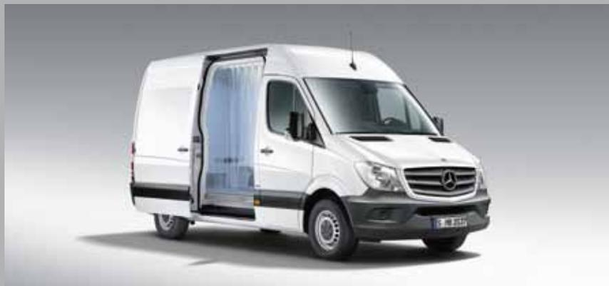
Le Sprinter avec module frigorifique<sup>1</sup> et rideau isolant : le froid reste ainsi confiné à l'intérieur de l'espace de chargement, même lorsque les portes sont ouvertes.
