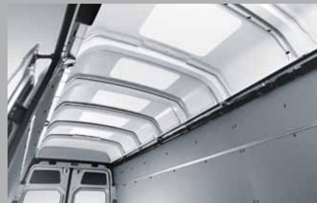
○ **Toit super surélevé.** Les bandeaux translucides dans la coque du toit super surélevé garantissent une bonne luminosité et font régner la clarté à l'intérieur du véhicule.
