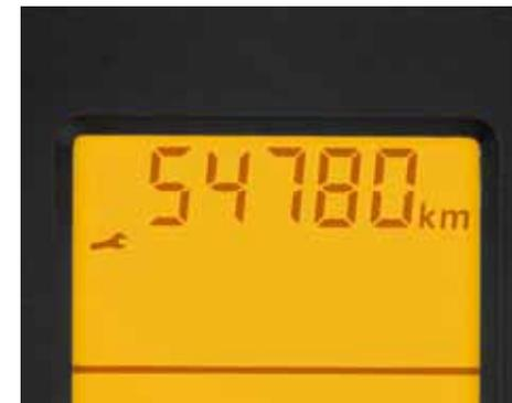
● **Indicateur dynamique de maintenance ASSYST.** Intervalles de vidange rallongés jusqu'à 60 000 km pour les véhicules diesel (40 000 km pour les véhicules essence) ou jusqu'à deux ans maximum.<sup>3</sup>
