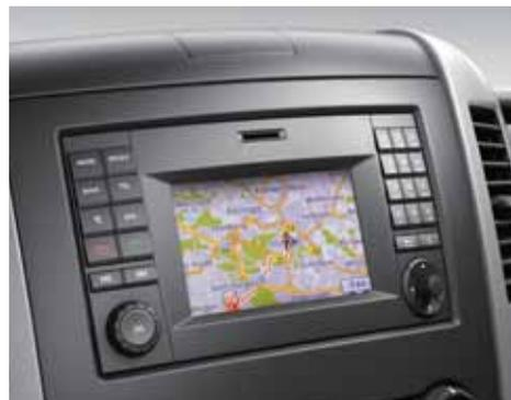
○ **Navigation.** Le système Becker® MAP PILOT® est un module de navigation entièrement intégré, basé sur l'autoradio Audio 15.
