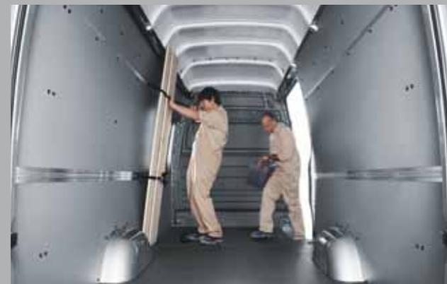
○ **Système modulaire de sécurisation et d'ancrage du chargement.** Proposés en option, les rails d'arrimage au sol, sur les parois latérales et sur le cadre de pavillon ainsi que les sangles aident à sécuriser le chargement.
