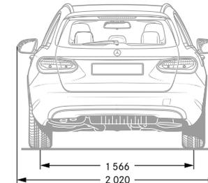
Cotes exprimées en millimètres. Les valeurs moyennes indiquées s'entendent pour le véhicule à vide avec dotation de série.
