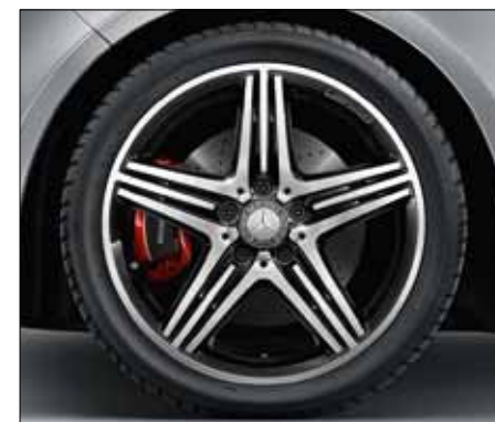
Jante alliage AMG à 5 branches avec pneus 235/40 R 18, finition noir et naturel brillant (de série sur CLA 250 Version Sport et CLA 250 4MATIC Version Sport, code 774).
