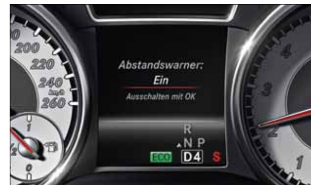
Le système COLLISION PREVENTION ASSIST déclenche une alerte visuelle et sonore lorsqu'il détecte une distance de sécurité insuffisante.
