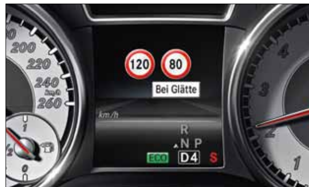
Le rappel de limitation de vitesse s'affiche sur le combiné d'instruments et sur le visuel central du système COMAND Online.
