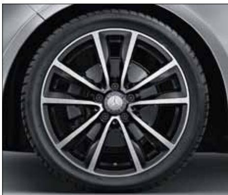
Jante alliage à 5 doubles branches avec pneus 225/40 R 18, finition noir et naturel brillant (inclus dans Pack Sport Black 3 sur Sensation, code 01R 4 ).
