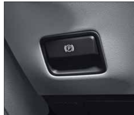
Frein de stationnement à commande électrique.
