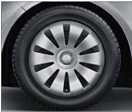
Jante acier avec enjoliveur à 10 trous, avec pneus 205/55 R 16 (non disponible en France). 1
