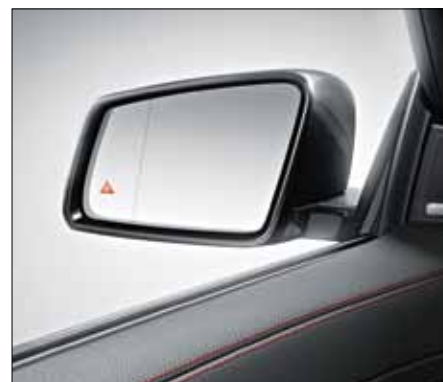
Pack d'assistance à la conduite avec avertisseurs de franchissement de ligne et d'angle mort.
